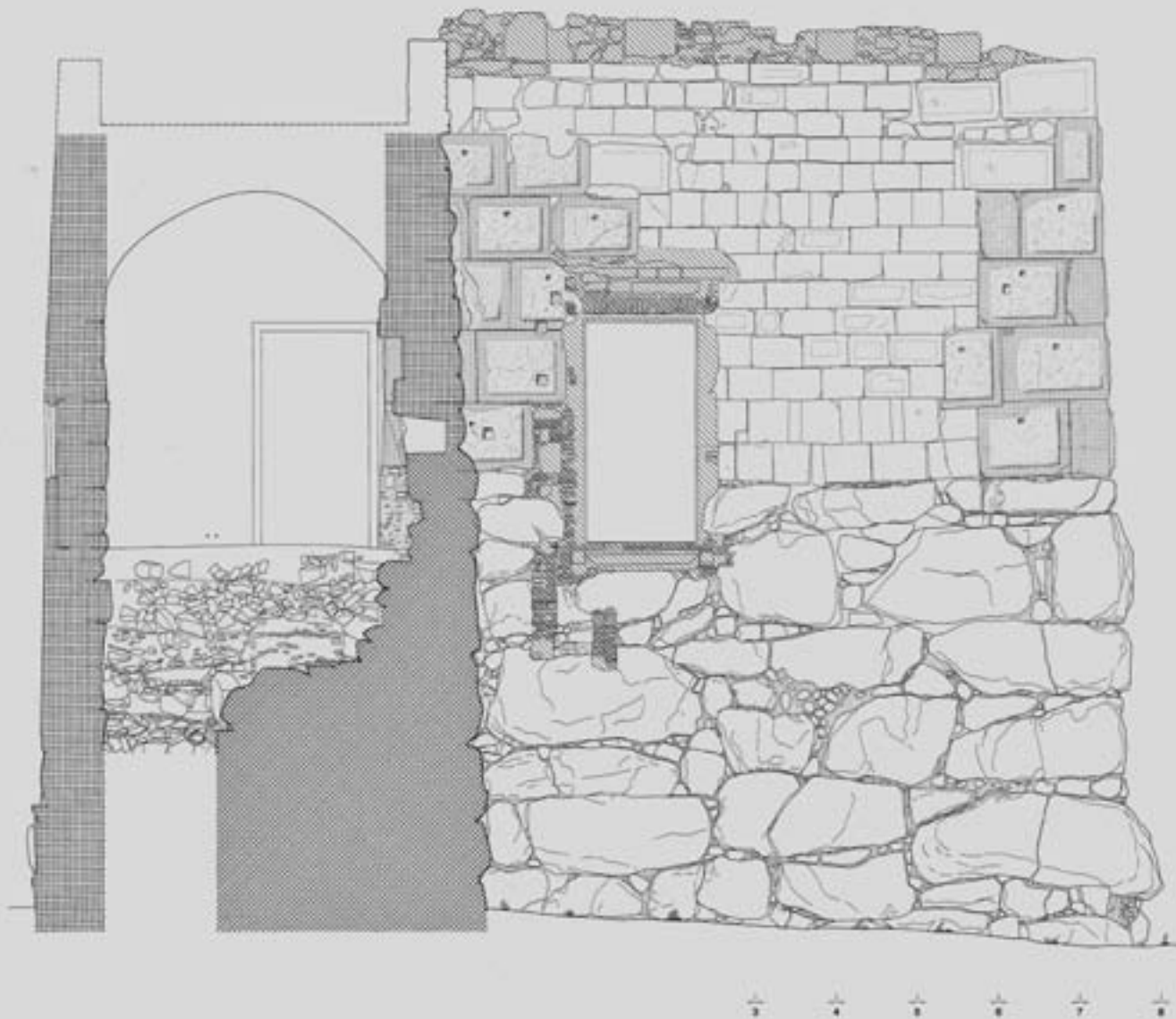
Fig. 31: Arriba. Alzado lateral de la Torre del Cabiscol incluyendo la sección estratigráfica del lienzo oriental correspondiente a la primera fase de la muralla según Th. Hauschild. Abajo. Planta de la torre y de los lienzos anexos mostrando la posición de los sondeos estratigráficos de Th. Hauschild (1983).
