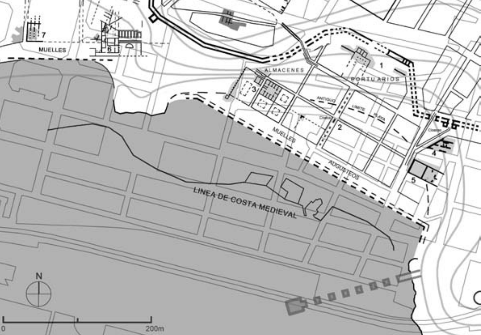
Fig. 165: Reconstrucción del sector portuario en época de Augusto. La línea de costa había ido avanzando paulatinamente y la utilización de grandes pilares para la construcción del muelle portuario muestra la preocupación por el arenamiento del puerto.
